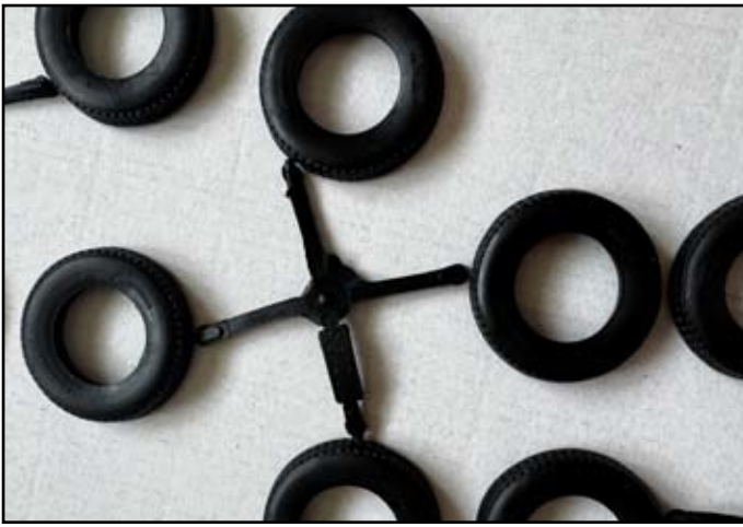
Die Gummibereifung besteht aus zwei Teilen je Rad.
