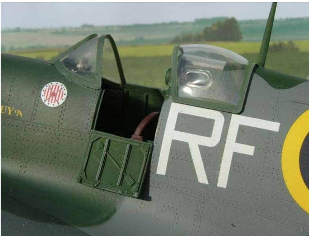
*Das Cockpit der Spitfire wurde vor der Montage bemalt. Das Instrumentenbrett besteht aus dem vorderen Instrumentenbrett bei dem die Armaturen ausgespart wurden und der Filmfolie die hinter dem Armaturenbrett angebracht wird. So entsteht das perfekte Finish.*
